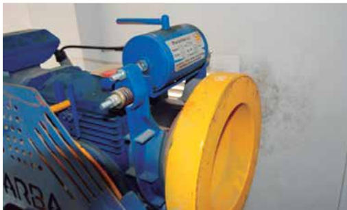
▼ VE. 41, 42 y 43. Máquinas tractoras con palanca de freno incorporada
